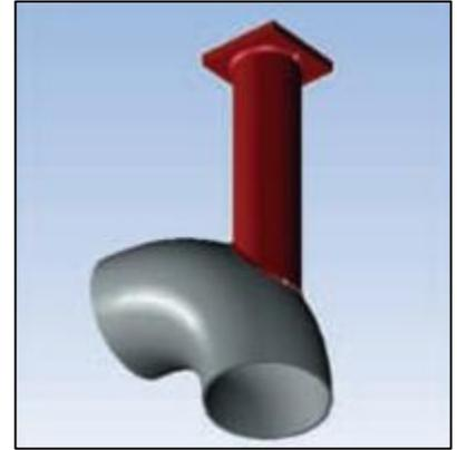
Si le tronçon (2-3) subit une élévation de température de  $200^{\circ}\text{C}$ , il tend à s'allonger de 12mm.
