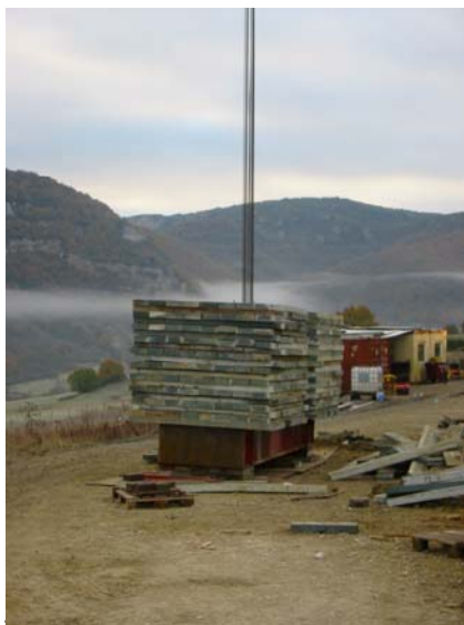
Photos 2: Dispositif d'ancrage de la charge au tablier
